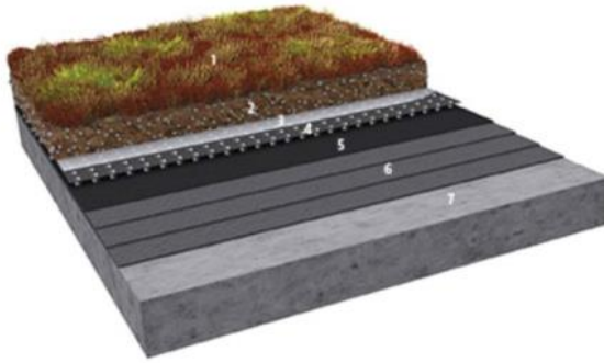
Kuva 6.2. Viherkaton rakenteet. Kuva: Leca Finland Oy.
