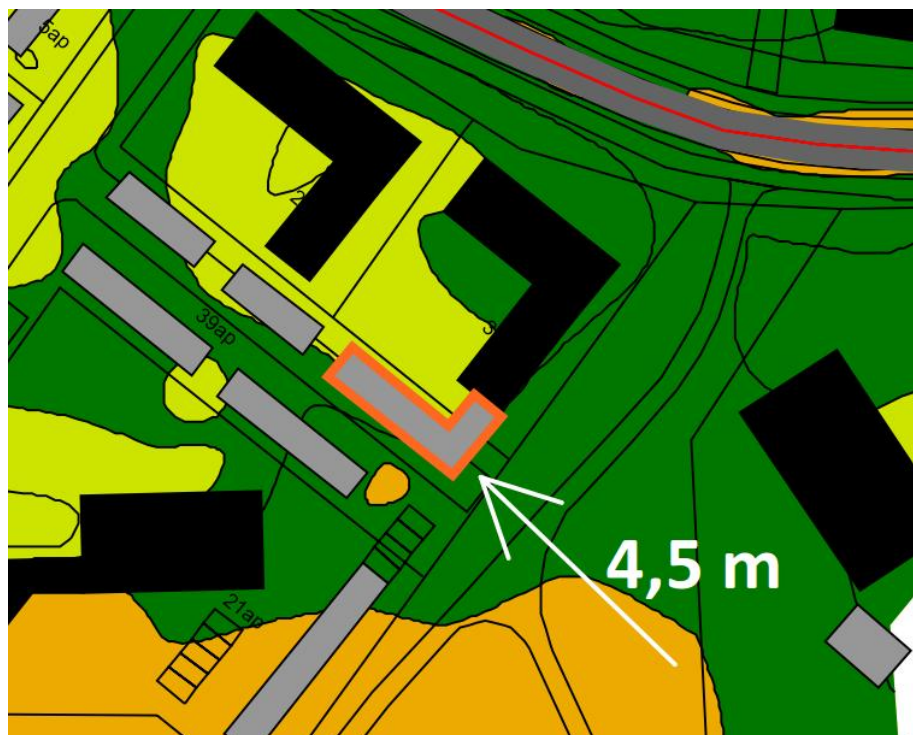
Kuva 2. Autokatokselle esitetty harjakorkeusvaatimus 4,5 m.
