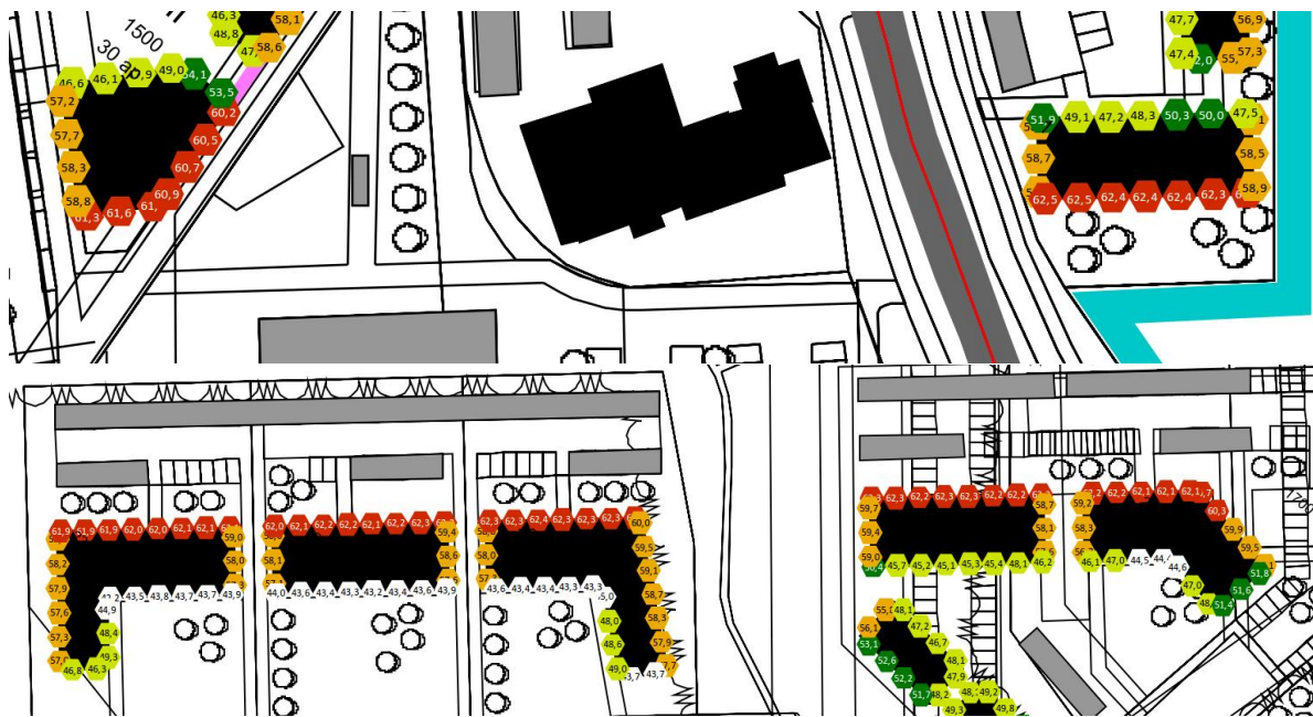
Kuva 3. Yöaikainen seinäpintaan kohdistuva keskiäänitaso, 60 dB ylittävien seinäpintojen piste-kohtaiset arvot.
